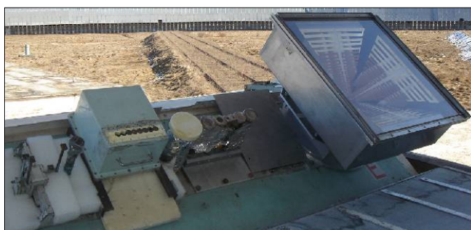
Рис. 26. Слева - фокальная линия вторичного зеркала № 1 с первичными облучателями радиометров на волны от 1.0 до 49 см, крайний справа- облучатель типа Eleven.Справа - входной сверхширокополосный блок дециметровых радиометров нового поколения.
