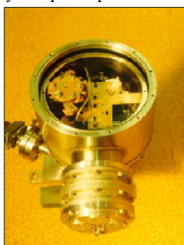
Рис. 27. Слева - входные кристаты радиометров 1,4 (слева) и 2,7 см. На обеих волнах наряду с двухлучевым приёмом реализован однолучевой режим работы с внутренней охлаждаемой нагрузкой в качестве эквивалента. Справа - компрессорная установка одной из четырёх микрокриогенных систем, охлаждающих входные части радиометров до 15 К.
