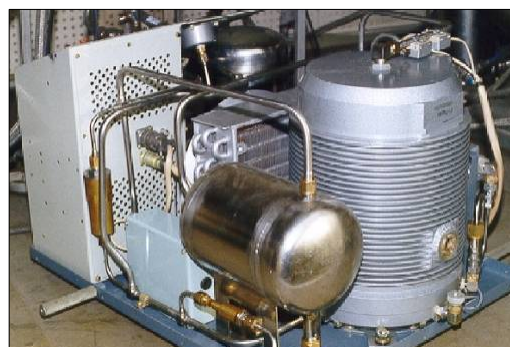
Рис. 27. Слева - входные кристаты радиометров 1,4 (слева) и 2,7 см. На обеих волнах наряду с двухлучевым приёмом реализован однолучевой режим работы с внутренней охлаждаемой нагрузкой в качестве эквивалента. Справа - компрессорная установка одной из четырёх микрокриогенных систем, охлаждающих входные части радиометров до 15 К.
