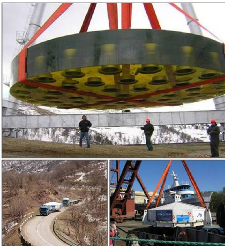
Рис. 10. Вверху - погрузка 6 метрового зеркала для транспортировки. Внизу – транспортировка ГЗ от башины БТА к пос. Нижний Архыз и погрузка ГЗ в Ростове.
