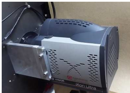
Рис. А.5. Камера iXon Ultra 888, смонтированная на фотополяриметре высокого временного разрешения.
