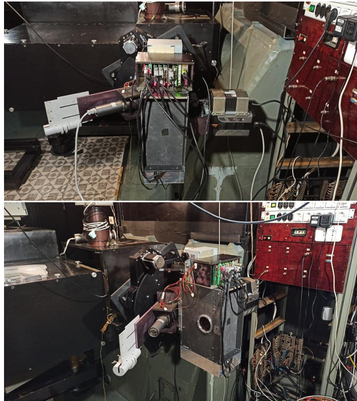
Рис. А.2. Фотополяриметр (ФПВР), установленный в фокусе Н1 БТА (сверху — вид с торца, снизу — вид сбоку).
