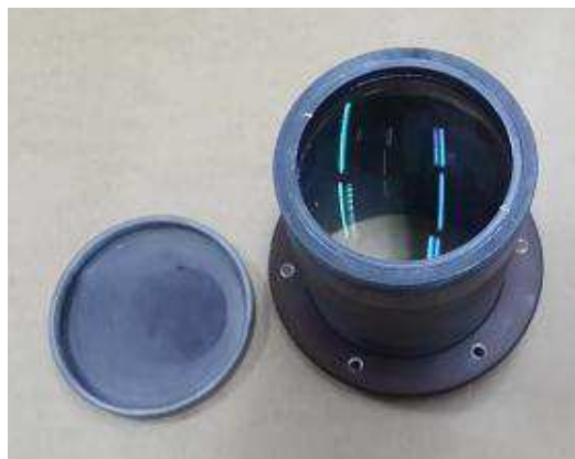
Рис. 4. Оптическая схема адаптера светосилы и его внешний вид в корпусе для монтирования на фланце. Кольцевая гайка с отверстиями используется для фиксации тубуса при установке.
